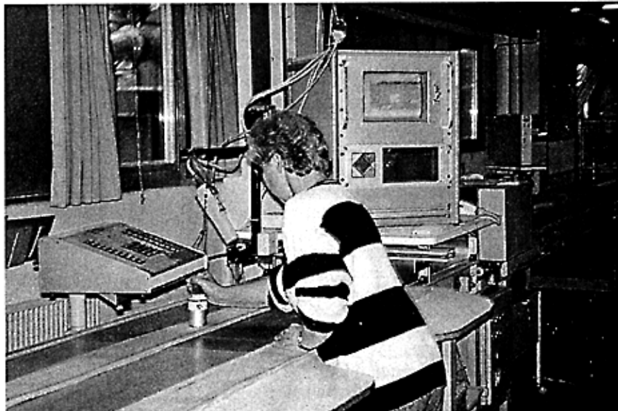
Abbildung 2 und 3 Integration des Farbvermessungssystems in eine vorhandene elektronische Vermessungsanlage mit Abmaßvorrichtung
